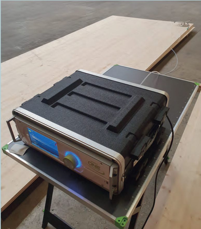
Abb. 1: Dreischichtige Massivholz-Rohplatte mit aufgesetzter FLEC-Messzelle und angeschlossenem Online-Messgerät
