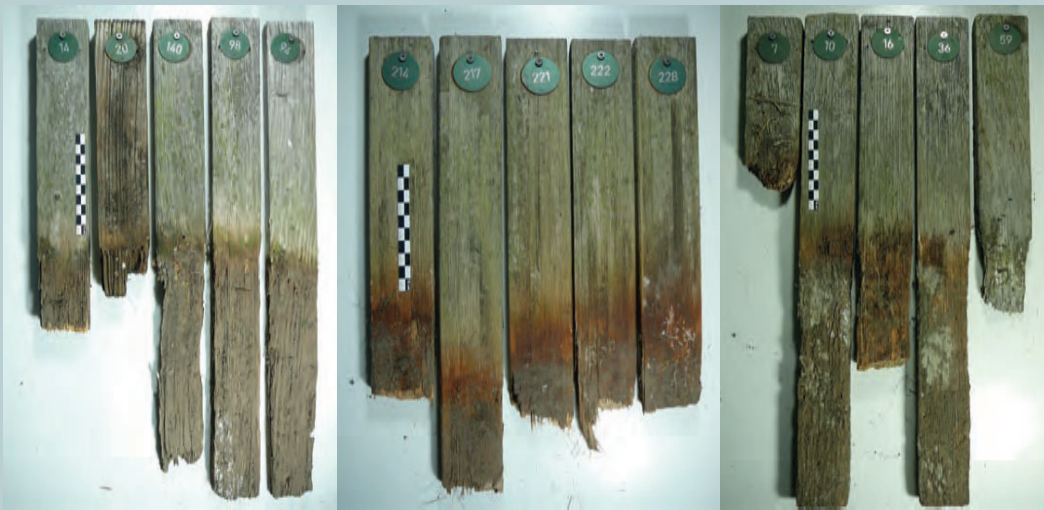
Abb. 1: Für die NGS-Sequenzierung beprobte Prüfstäbe bzw. deren Bruchstücke: je fünf Stäbe von links nach rechts: Lärchenkernholz, Bambus-Scrimber (komprimierter, mit Klebharz verpresster Bambus) sowie Eichenkernholz nach acht bis zehn Jahren Exposition im Erdkontakt gemäß DIN EN 252.
