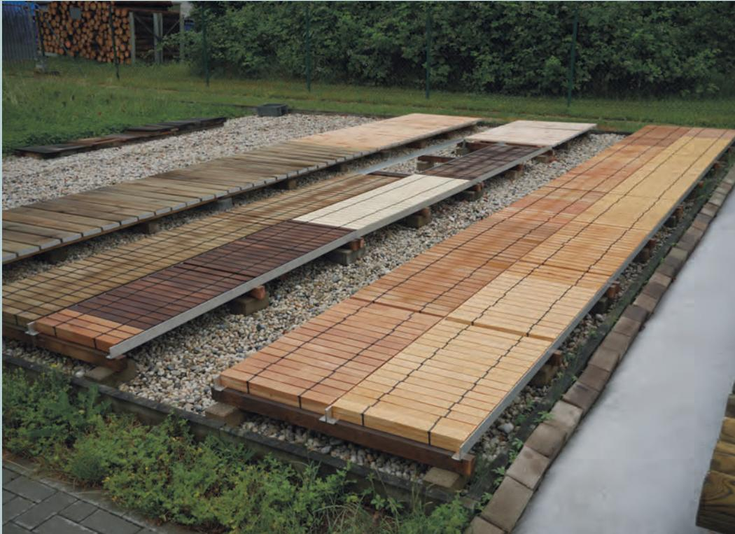
Abb. 1: Bündeltest-Prüfkörper im IHD-Freilandversuchsfeld für Gebrauchsklasse 3
