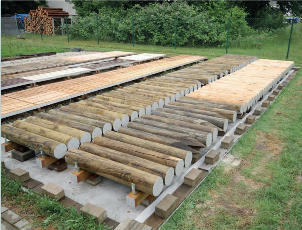
Abb. 2: Palisaden-Abschnitte im IHD-Freilandversuchsfeld für Gebrauchsklasse 3
