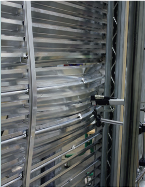
Abb. 1: Prüfung der Absturzsicherheit eines Lüftungsgitters
