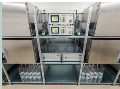
Abb. 2: Modular aufgebautes Prüfkammersystem bestehend aus vier 0,225 m 3 Edelstahlprüfkammern für Emissionsprüfungen gemäß ausgewählter internationaler Prüfstandards
