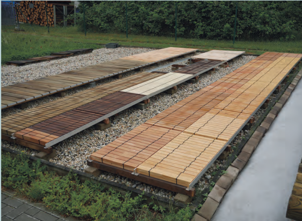
Abb. 1: Bündeltest-Prüfkörper im IHD-Freilandversuchsfeld für Gebrauchsklasse 3
